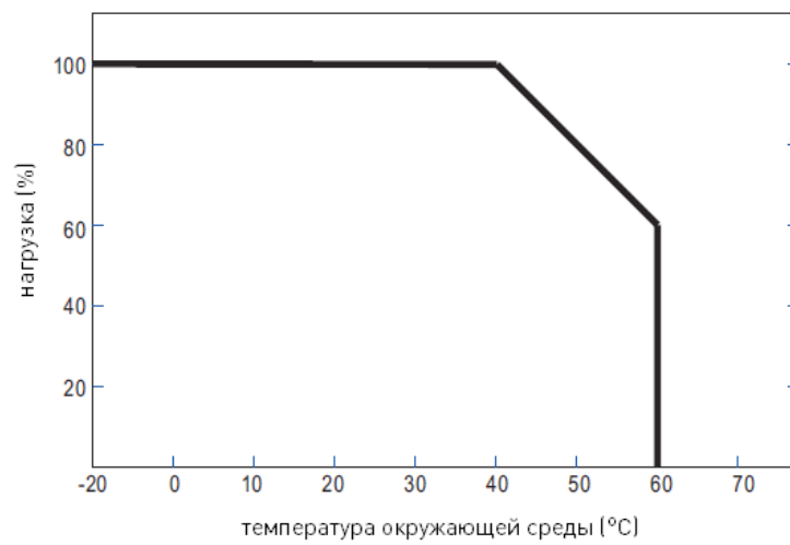
Рис. 4. Зависимость нагрузки от температуры окружающей среды
