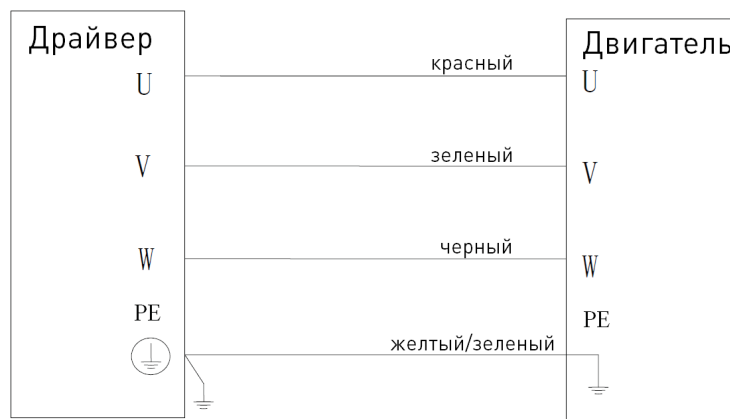
Рис. 4. Схема подключения питания силовой части драйвера
