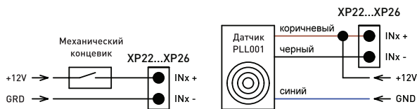
Рис. 4. Подключение концевых датчиков
