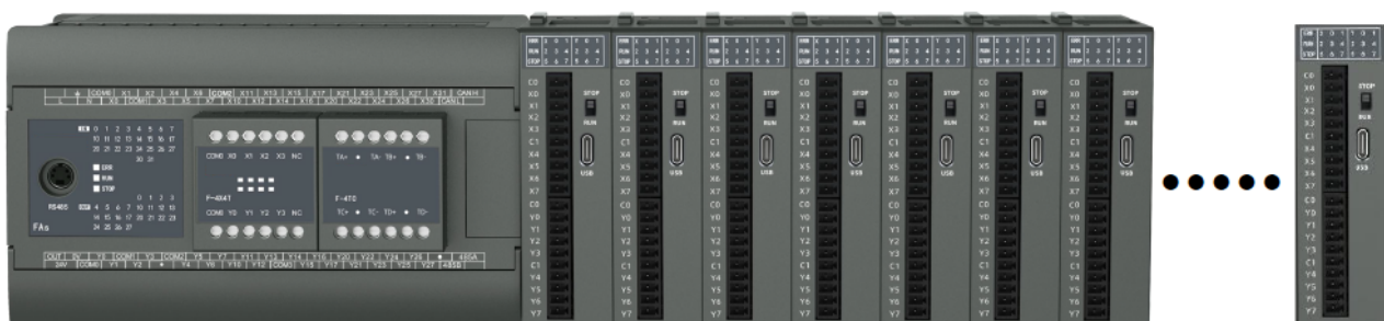
Рисунок 5 – Подключение до 64 внешних модулей.
