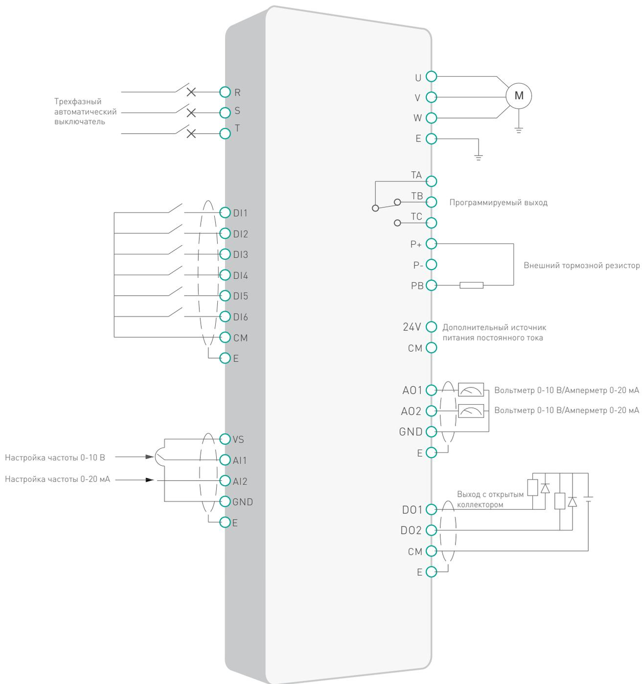
Рисунок 1 – Типовая схема подключения частотного преобразователя DX100.
