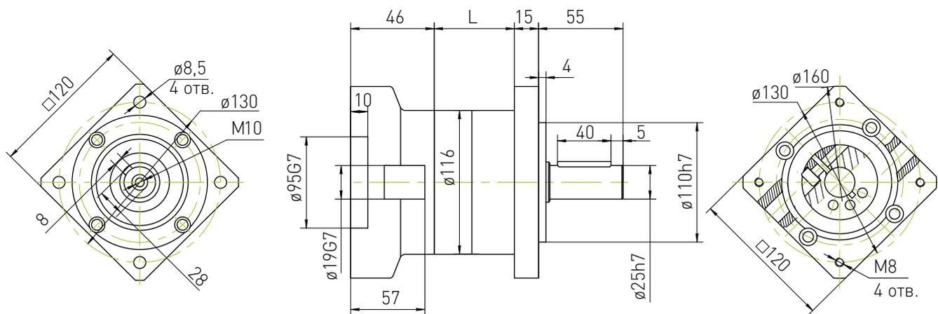
Рис. 1. Габаритные и установочные размеры изделий
