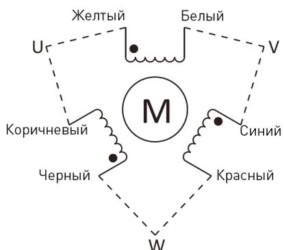
Рис. 7. Цветовая маркировка выводов фаз двигателя
