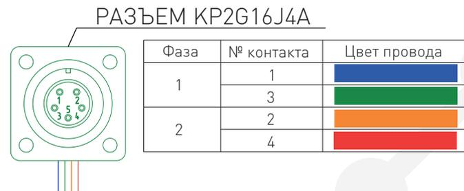
Рис. 4. Схема контактов разъема двигателя
