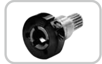
輸入端與馬達的連結機構，採用筒夾式的鎖緊經動平衡分析，以確保在高輸入轉速下結合界面的同心度和零背隙的動力傳遞。
