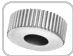
齒輪材質選用鉻鉬釩合金鋼，經調質熱處理至基材硬度 HRC25 度，再利用氣體氮化方式將齒輪表面硬度提升至 600HV，以獲得最佳的耐磨耗及耐衝擊韌性。
