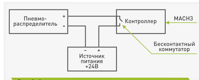
Рис. 2. Схема подключения питания пневмораспределителя
