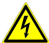
Рисунок 8 — Опасность поражения электрическим током.
