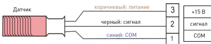
Рис. 10. Подключение индуктивного NPN датчика
