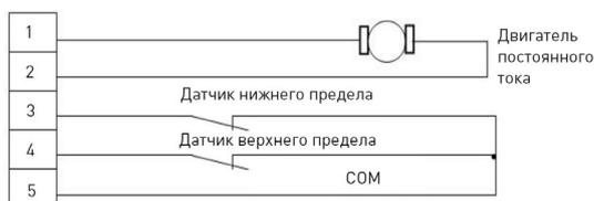
Рис. 13. Подключение к подъемнику резака
