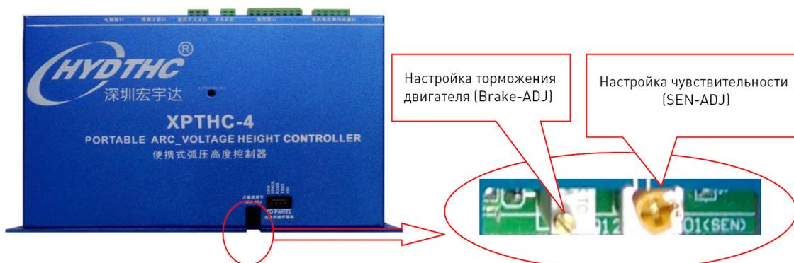
Рис. 6. Настройка торможения и чувствительности ХРТНС-4Н
