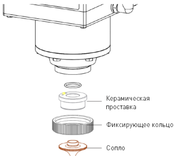
Рисунок 29 – Модуль сопла (для лазерной головки BS08K-8).
