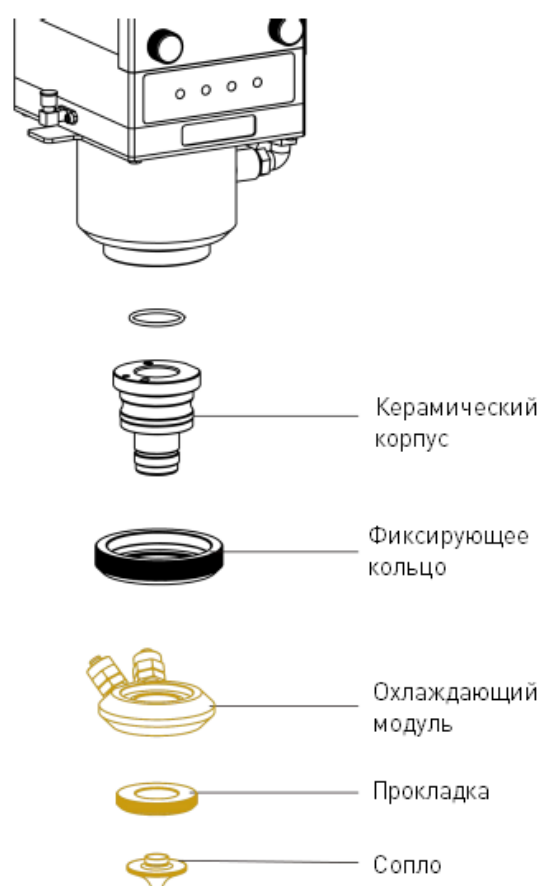
Рисунок 30 – Модуль сопла (для лазерных головок BS12K-12, BS15K-15, BS20K-20).
