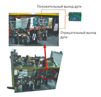
Рис. 17. Плазменная резка с возбуждением высокой частоты пилотной дуги
