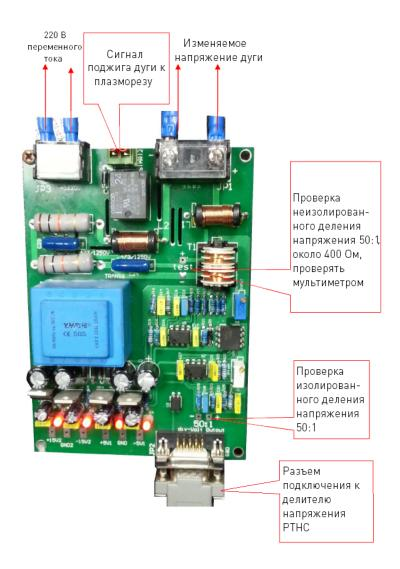
Рис. 12. Изолированный делитель напряжения
