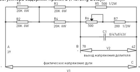
Рис. 11. Неизолированный делитель напряжения 100:1
