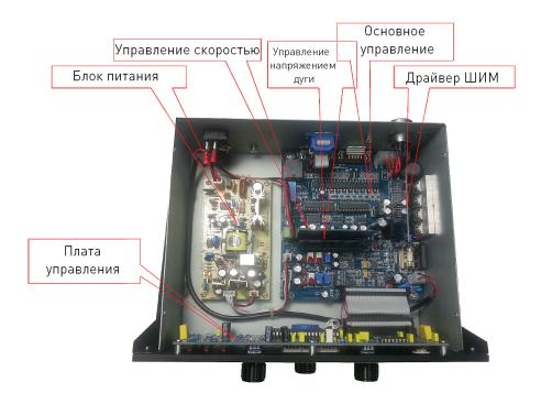
Рис. 4. Внутреннее устройство PTHC-200DC
