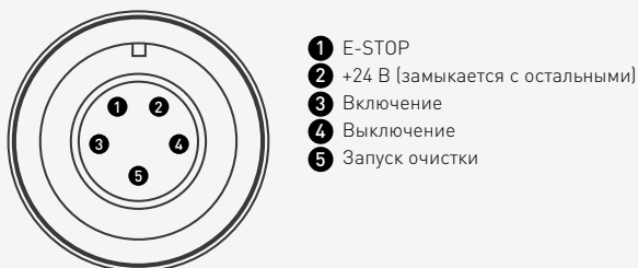
Рис. 16. Распиновка разъема подключения к системе с ЧПУ
