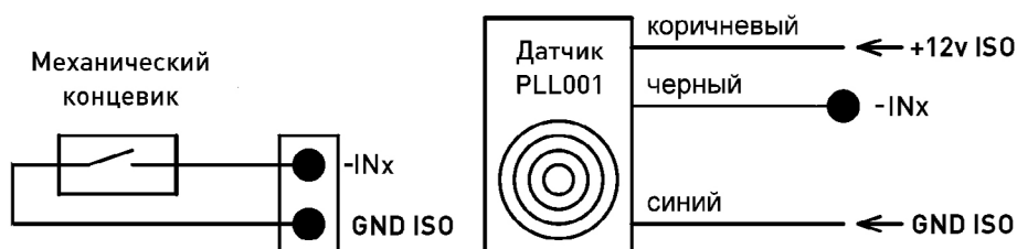
Рисунок 8 — Подключение датчиков.
